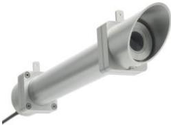
*Pierheliómetro:* Miden la radiación solar directamente. Es decir, el valor de energía por unidad de área y unidad de tiempo incidente sobre un plano perpendicular a la posición del sol en el cielo. Este detector necesita estar montado en un seguidor solar en su camino.
